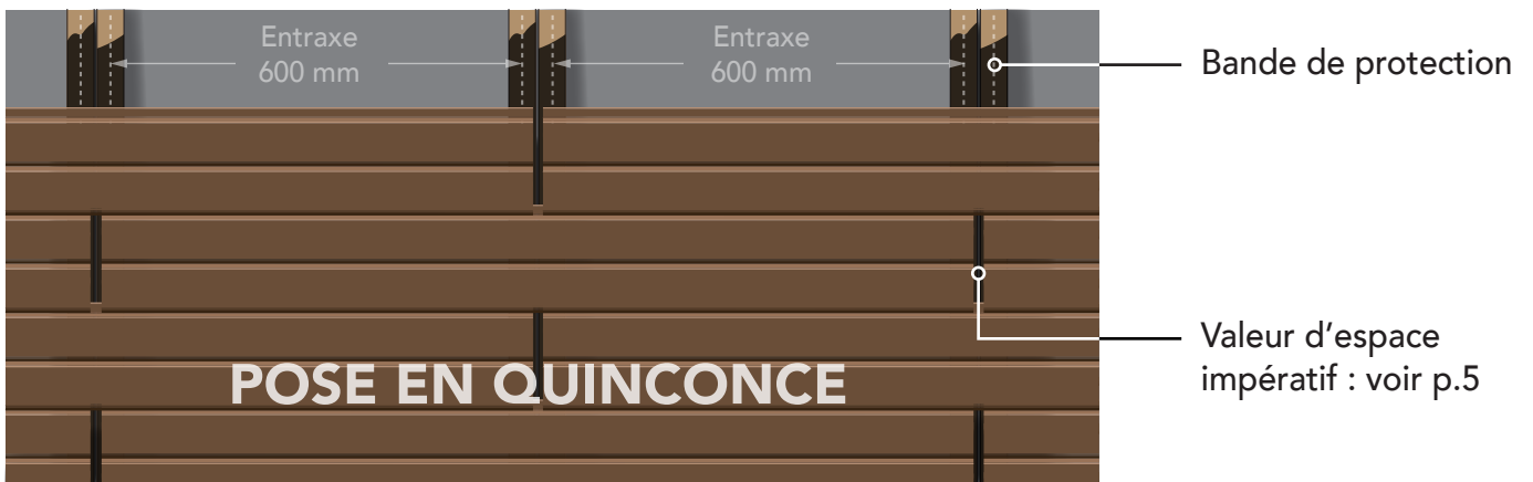
Fixation des lames à leur extrémité sur un tasseau = Stabilité
